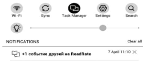
Панель уведомлений обеспечивает простой доступ к настройкам интернет-соединения по Wi-Fi, регулировке Подсветки, Синхронизации сетевых приложений, Диспетчеру задач, Настройкам устройства и Поиску. Также здесь отображаются новости с ReadRate и уведомления от других сетевых сервисов PocketBook.
