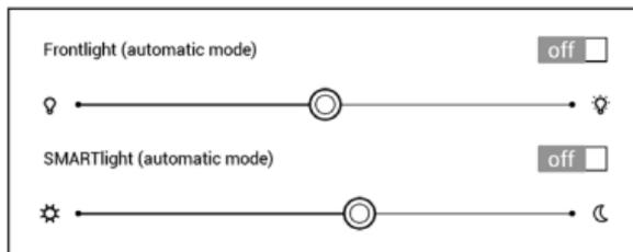
**1. Contrôle général Frontlight.** Cela inclut un commutateur MARCHE/ARRÊT pour activer et désactiver l'éclairage et une molette luminosité.
