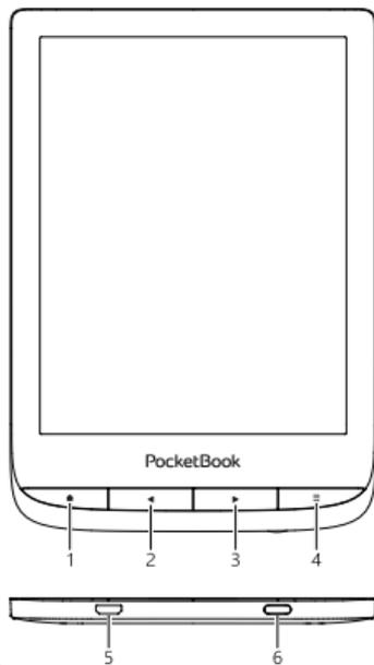
**REMARQUE:** vous pouvez également programmer des touches dans les *Paramètres > Personnalisation > Programmation des touches*. Le fonctionnement des touches de navigation et de défilement des pages dépend de l'orientation de l'écran.
