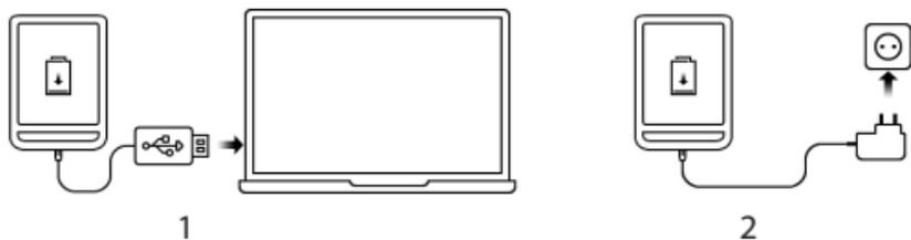
Die vom Ladegerät bereitgestellte Leistung muss für die Funkausrüstung zwischen 2,5 und 5 Watt liegen, um eine maximale Ladegeschwindigkeit zu erreichen.
