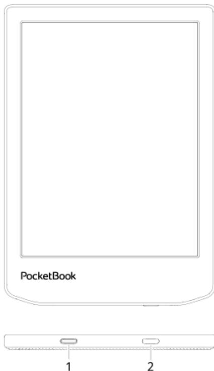
**1. USB Type-C-Anschluss** – zum Anschließen des Geräts an einen Computer oder an ein Ladegerät mittels eines USB-Kabels.
