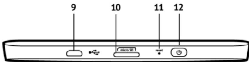
**9.** Порт micro-USB – для подключения Устройства к ПК или зарядному устройству (поставляется отдельно)
